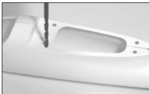
6. Расположите крепление крыла для проверки того, правильно ли Вы наметили отверстия. Просверлите 3,5 мм отверстия в отмеченных местах.
