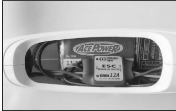
28. Прикрепите одну часть липучки к аккумулятору, другую к фюзеляжу. Согласно инструкции производителя приемника и регулятора скорости соедините провода и настройте функцию V-образного хвостового оперения. Регулятор скорости и приемник должны располагаться как указано на фото.
