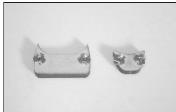
7. Установите глухие гайки как указано на рисунке.
